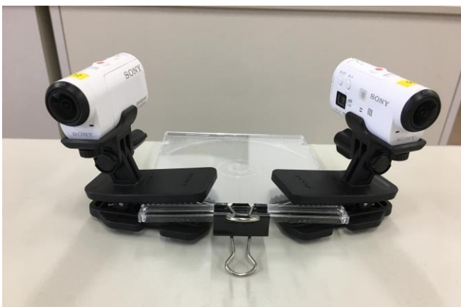
図 1. 2 台の個別カメラをクリップ固定した録画装置。手前のクリップで角度を付けている。
